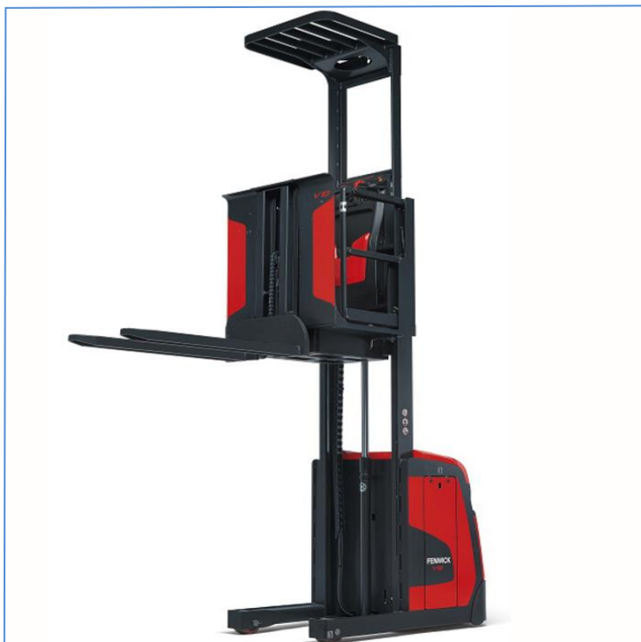
Chariots à poste de conduite élevé (Hauteur plancher <1m20)
