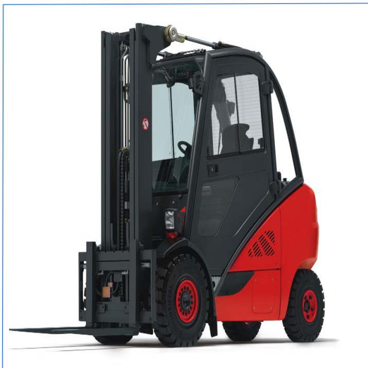
Chariots frontaux en porte à faux (Capacité nominale <6 Tonnes)
